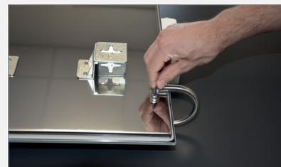
Das Gerät muss durch einen Installationsfachbetrieb mit Verwendung des mitgelieferten Montagesets an der Wand montiert werden (Bohrschablone mit Anleitung in der Verpackung). Nach dem Einhängen des Infrarot-Heizelementes an der Wand immer alle Schrauben mit dem beigelegten Gabelschlüssel zur Sicherung fest anziehen.
